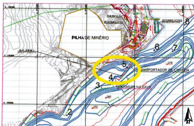
Figura 10. Posição ótima para britagem na cava –Mina de Chapada.
