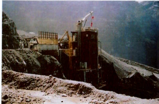
Figura 3. Britador in pit semi-móvel na mina de cobre-ouro Grasberg operada pela empresa P.T. Freeport Indonesia.
